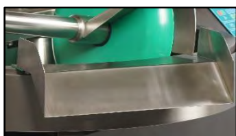
IMG. 9: Bandeja extractora
